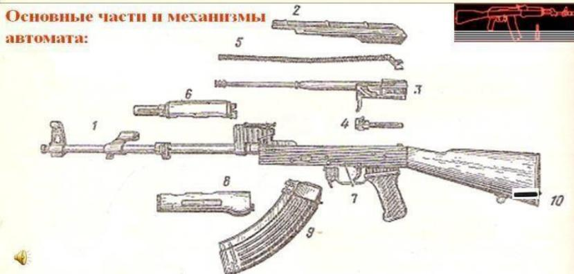
**1**-ствол со ствольной коробкой, с прицельным приспособлением и прикладом, **2**-крышка ствольной коробки, **3**-затворная рама, **4**-затвор, **5**-возратный механизм, **6**-газовая трубка со ствольной накладкой, **7**-ударно-спусквомеханизм, **8**-цевье, **9**-магазин, **10**-пенал с принадлежностями
